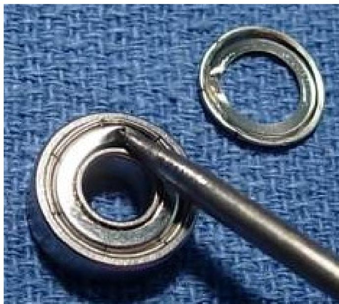
Die OP um vercrimpte Deckel von ZZ Lager abzunehmen ist die Ausnahme wenn kein 2RS oder offenes Lager im benötigten Maß erhältlich ist. Es muss sehr vorsichtig eingestochen werden um den Käfig mit den Kugeln nicht zu beschädigen. Sonst Tonne.....
